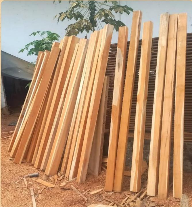
**Tablas:** Son uno de los productos más comunes de madera aserrada. Se obtiene al cortar troncos en piezas largas y delgadas, con un grosor uniforme. Estas tablas son utilizadas en una gran variedad de aplicaciones diferentes, desde la construcción de paredes hasta la fabricación de muebles y suelos.
